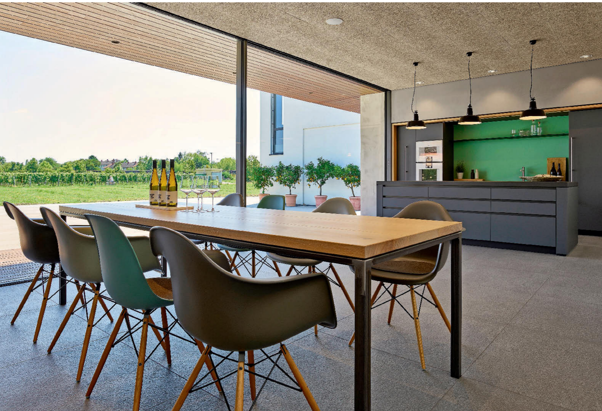
/ Reduzierter Materialeinsatz: Massive Eiche, Schwarzstahl und matte Schichtstoffoberflächen prägen den Innenausbau des neuen Verkaufs- und Präsentationsraumes des Weingutes Hensel im pfälzischen Bad Dürkheim – die Decke aus Zementfaserplatten (Heradesign) schafft eine optimale Raumakustik.
